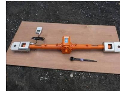
斜引き緊張装置(斜材方向)
