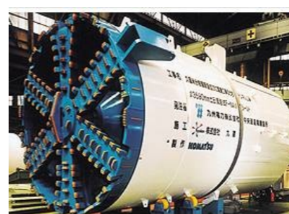
シールド工事(マシン外径φ3,590mm)
