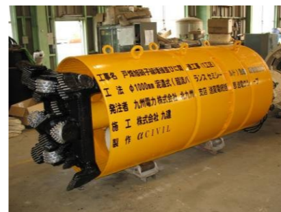
推進工事(マシン外径φ1,290mm)
